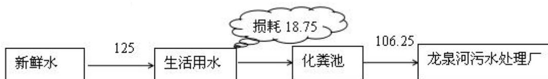
图 1 水平衡图 (单位 t/a)
