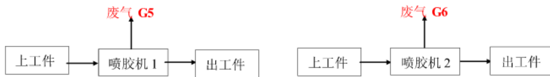
图 4-8 自动喷粘合剂生产工艺流程图
