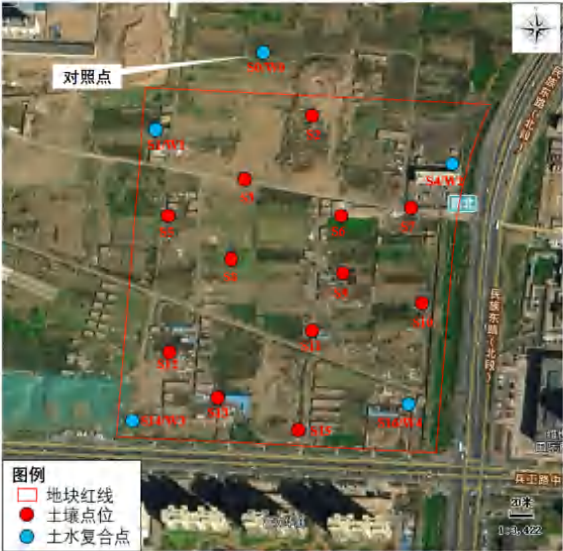
图 4.2-1 本项目地块采样点布设图
